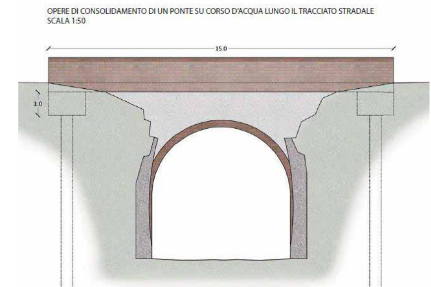
OPERE DI CONSOLIDAMENTO DI UN PONTE SU CORSO D'ACQUA LUNGO IL TRACCIATO STRADALE SEZIONE - SCALA 1:20
